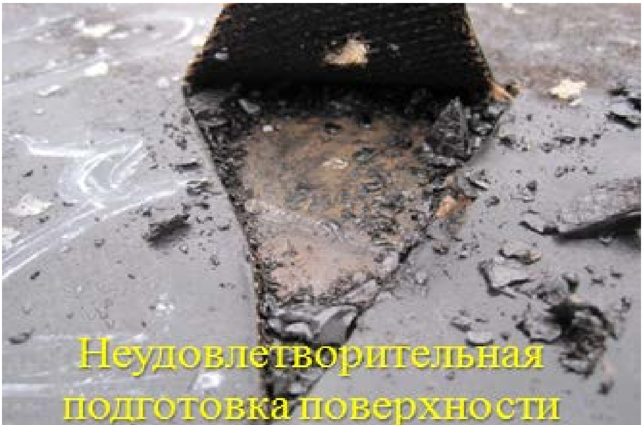
Рис.46 Некачественная подготовка поверхности тела трубы
