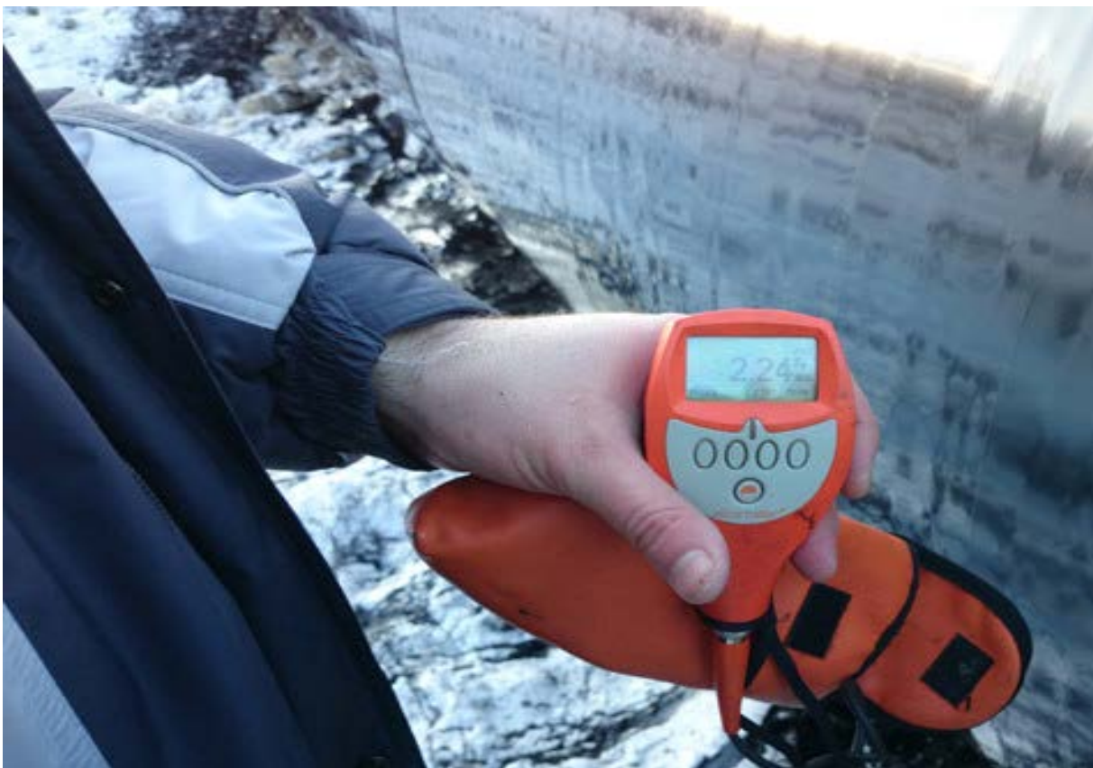
Рис.39 Недостаточная толщина ЗП «ТРАНСКОР-ГАЗ»
