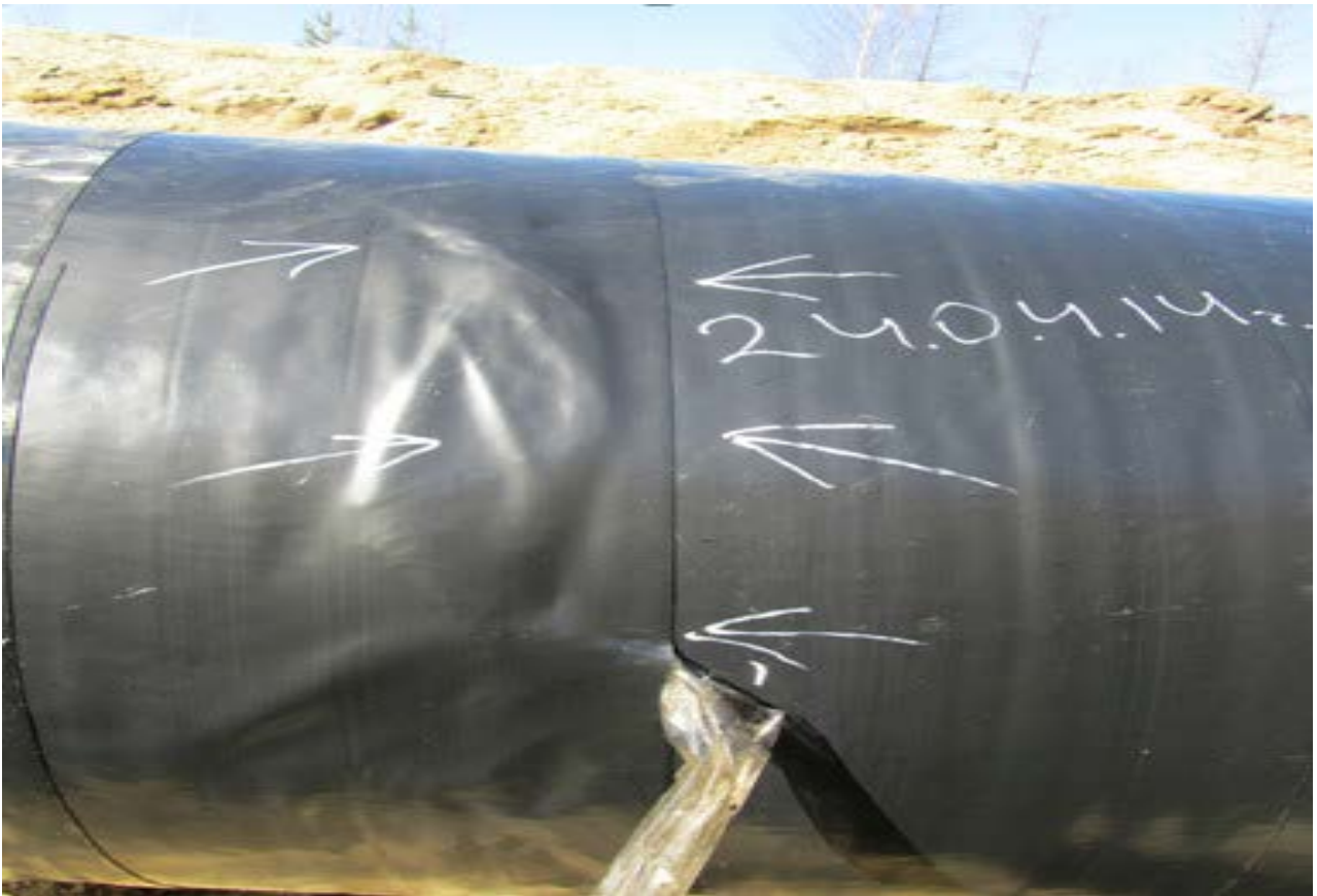
Рис.42 Присутствие антиадгезионной пленки под защитной оберткой ЗП «АРМАС»
