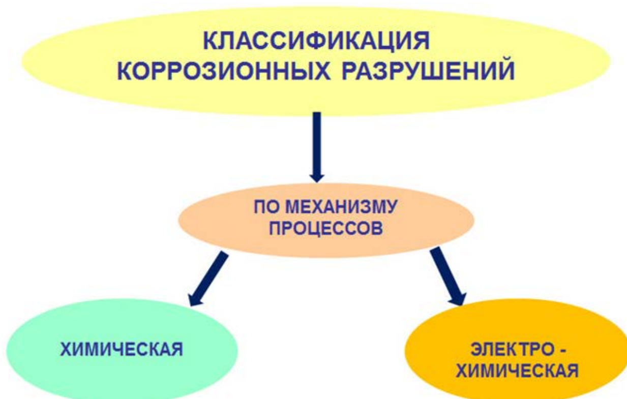
Рис.2 Классификация коррозионных разрушений
