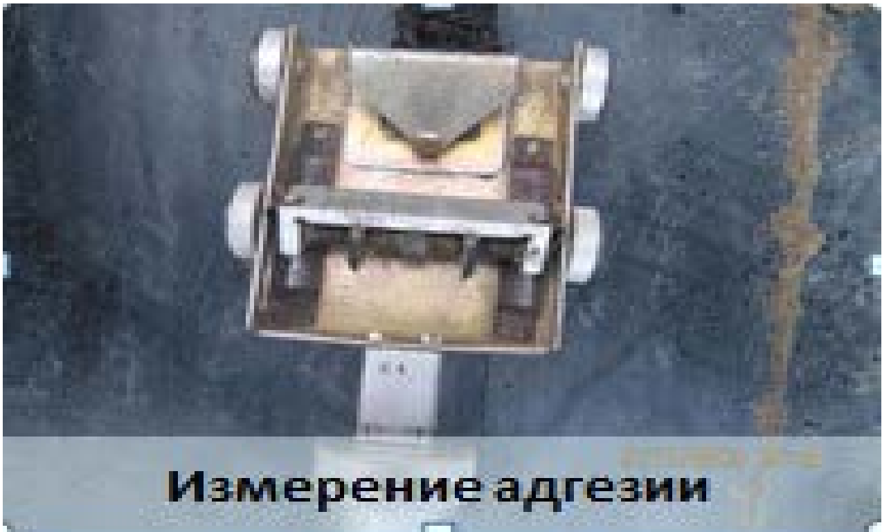
Рис.71 Измерение адгезии защитного покрытия
