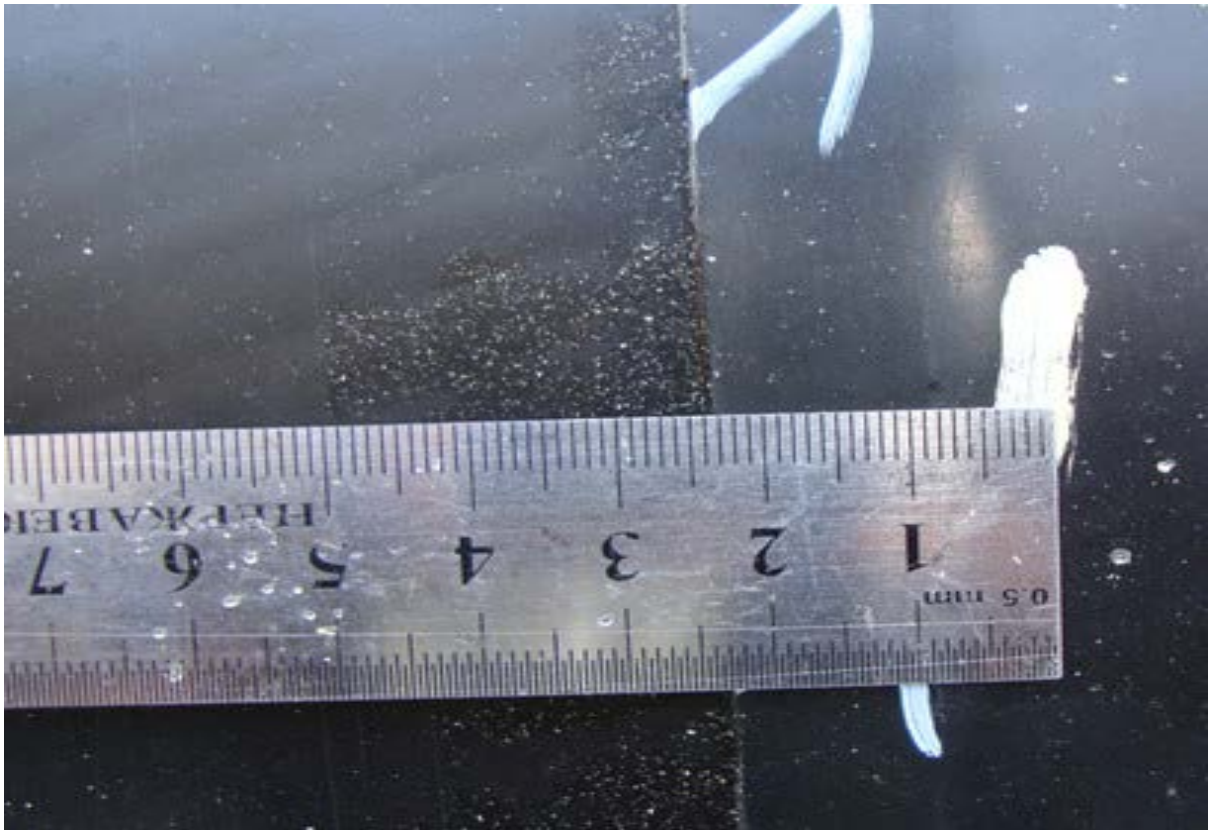
Рис.38 Ширина нахлеста менее 30 мм ЗП «ТРАНСКОР-ГАЗ»
