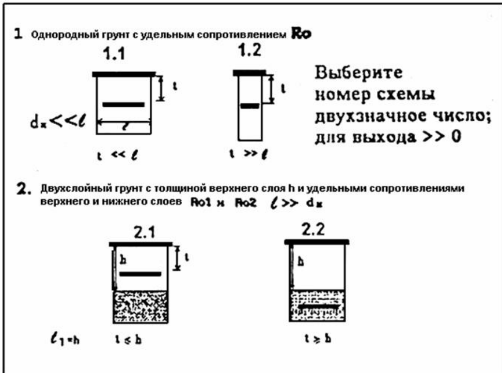
Рис.С1. Кпрограмме САГ: схема возможных расположений вертикального анода в однородном(1.1, 1.2) и двухслойном грунтах (2.1-2.5) для выбора расчетного варианта
